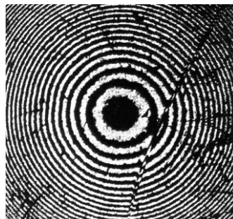
Abb. 6.4: Beispiel einer Interferenzaufnahme (Kugelfläche mit Kratzspur)
